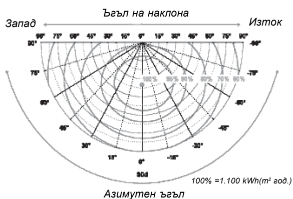
Фиг. 6.15. Годишна инсолация в зависимост от ориентацията на приемащата повърхност
